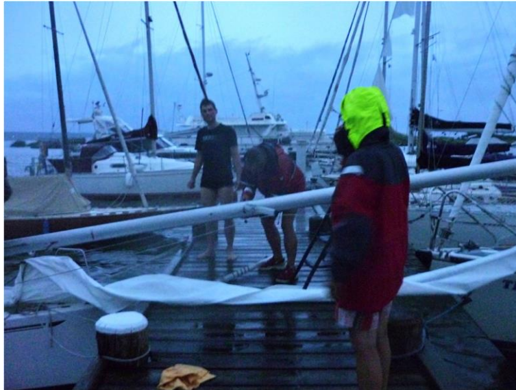
Orkan im Hafen Krummin: Ein Mast ist gebrochen, im Hintergrund eine zerfetzte Fock.
