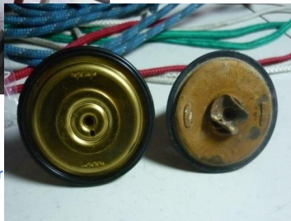
Fehlersuche: Ist der Kühlwasserschlauch nicht durchgängig? (oben); Der Übeltäter: Verrosteter Thermostat (rechts)
